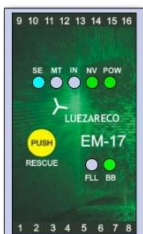
Ascensor en planta con puertas cerradas finalizando la marcha
